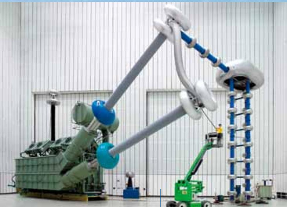
Es müssen daher hinter dem Generator zunächst einmal **Transformatoren** eingebaut werden, die die Wechselspannung auf 800.000 Volt hoch transformieren. Danach installiert man riesige Gleichrichter, Thyristoren genannt, die aus der Wechselspannung eine Gleichspannung machen. Am Ziel muss umgekehrt die Gleichspannung zunächst wieder in eine Wechselspannung rückgewandelt und anschließend runter transformiert werden, damit wir unsere Geräte wie gewohnt betreiben können.
