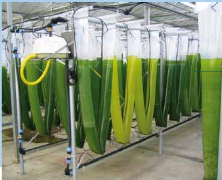
◀ In dieser Testanlage rückt man einem Teil der Abgase des Braunkohlekraftwerks Niederaußem mithilfe von Algen zu Leibe. Diese gedeihen in V-förmig aufgehängten Kunststoffschläuchen und ernähren sich vom Kohlendioxid in den Abgasen. Rund zwölf Tonnen CO<sub>2</sub> binden die Mikroalgen auf diese Weise pro Jahr – ein verschwindend geringer Teil der 27 Millionen Tonnen, die Niederaußem jährlich produziert. Für kleinere Kraftwerke könnten die Algen aber durchaus eine Option sein. (Bild: RWE)
