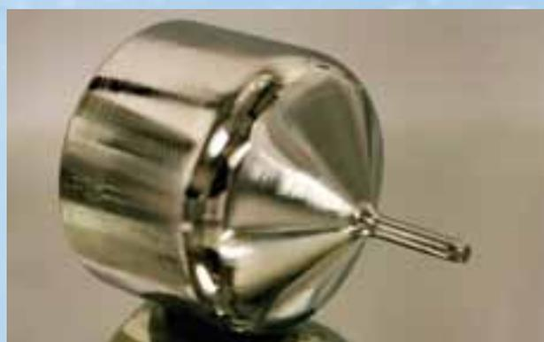
▲ Baustoff für Solarzellen ist eigentlich Silizium. Kommt es allerdings mehr auf Effizienz an als auf den Preis, ist Germanium besser geeignet – zum Beispiel für Solarmodule im Weltraum. Die Aufnahme zeigt einen Germanium-Einkristall mit einem Durchmesser von 110 Millimetern. (Bild: Leibniz-Institut für Kristallzüchtung Berlin; Foto: K. Banse, Ch. Frank-Rotsch)
