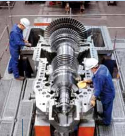
◀ Techniker an einer 50-Megawatt-Dampfturbine, wie sie hauptsächlich als Generatorantrieb zur Stromerzeugung eingesetzt wird. Gut zu erkennen sind die Turbinenschaukeln im oberen Bildteil. (Bild: Siemens-Pressebild)
