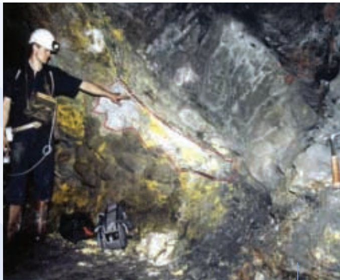
☛ Die Überreste eines der zwei Milliarden Jahre alten natürlichen Kernreaktoren von Oklo (gestrichelt umrandet): Heute sind sie für Menschen ungefährlich. (Foto: R. Loss, Curtin University of Technology, Australien)
