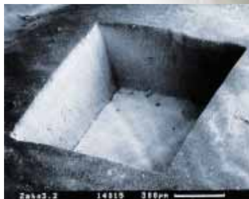
◀ Diese vermeintliche Baugrube ist ein nur 0,5 Millimeter tiefes Loch, das mit ultrakurzen Laserpulsen in einen menschlichen Zahn geschnitten wurde. Der Blick durch das Rasterelektronenmikroskop zeigt, dass bei der exakten Aushöhlung keine weiteren mechanischen oder thermischen Schäden auftraten.
